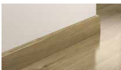
Плинтус прямой PGSKR(-), 2400 x 14 x 58 мм PGPSKR(-), 2400 x 14 x 77 мм (см. номер артикула в таблице соответствия) Цвет: соответствует цвету пола Поверхность: устойчиво к износу и царапинам ламинированное напольное покрытие Основа: МДФ
